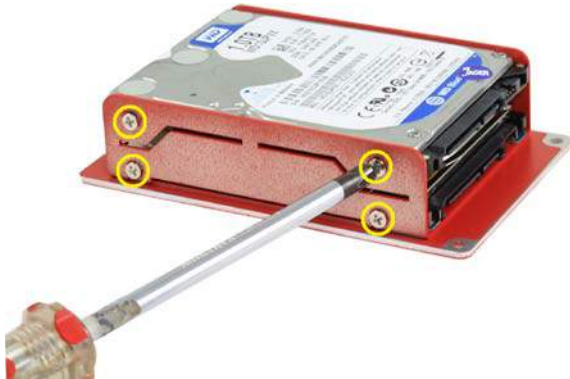
(HDD bracket of Nuvo-5000E/P)
